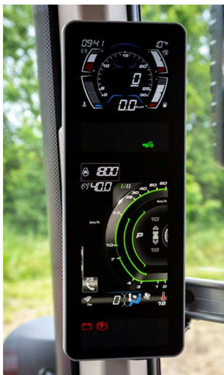
Il cruscotto è stato sostituito con il nuovo terminale digitale "MF vDisplay", posizionato sul montante destro
