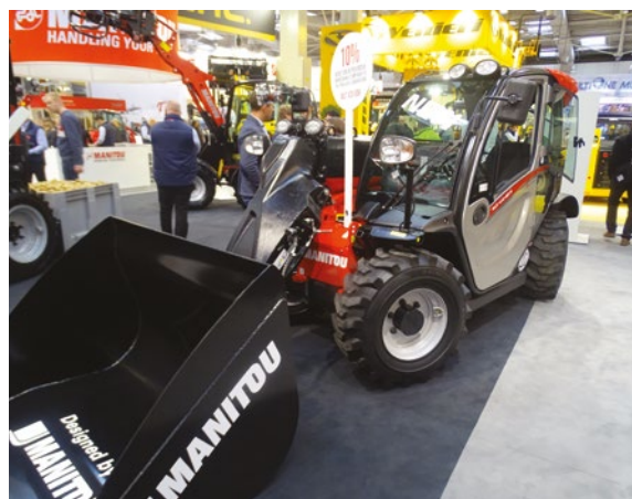
L'ultracompatto MLT 420-60 H è una delle macchine più compatte sul mercato grazie ai suoi 1,97 m di altezza e 1,49 m di larghezza
