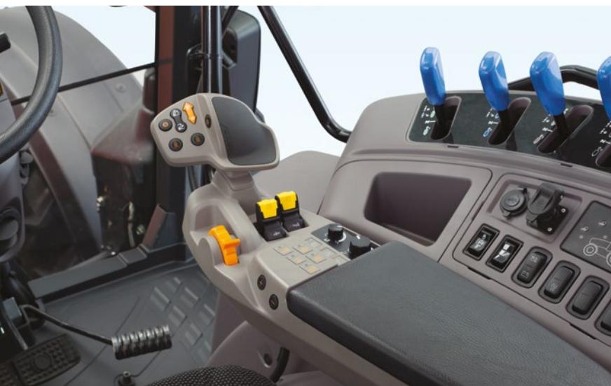
In cabina troviamo la nuova leva multifunzione sul bracciolo con inversore, memoria funzioni motore, comando sollevatore e cambio automatico
