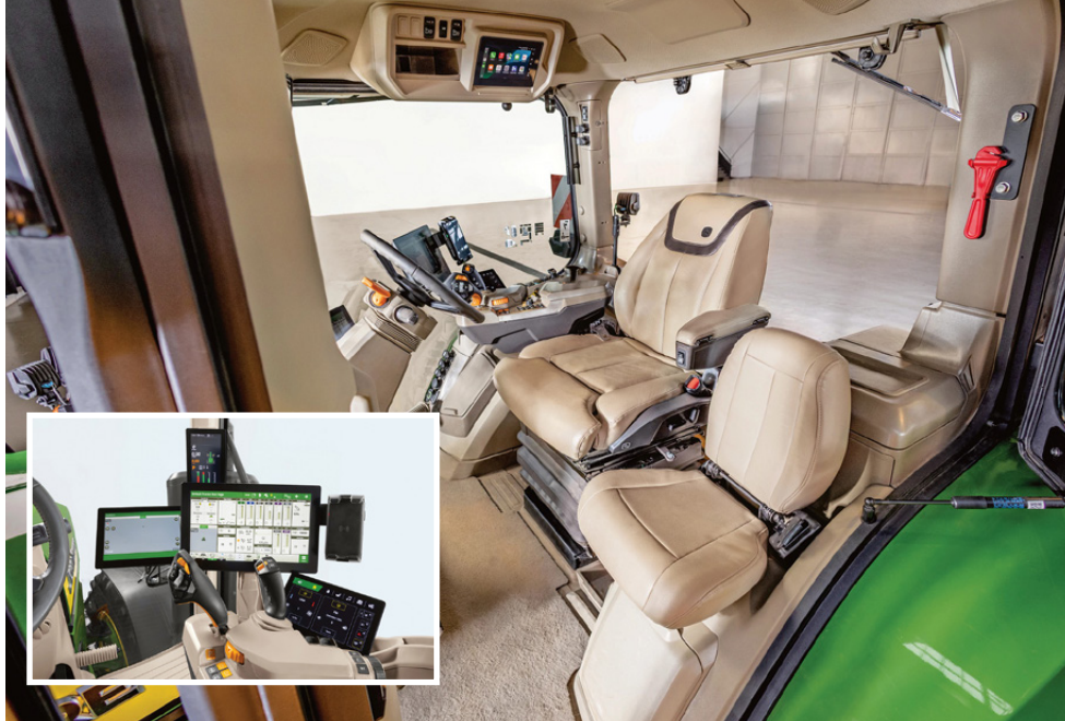
La cabina CommandView 4 è dotata di un CommandArm ridisegnato con Convenience Display integrato (nel riquadro)
