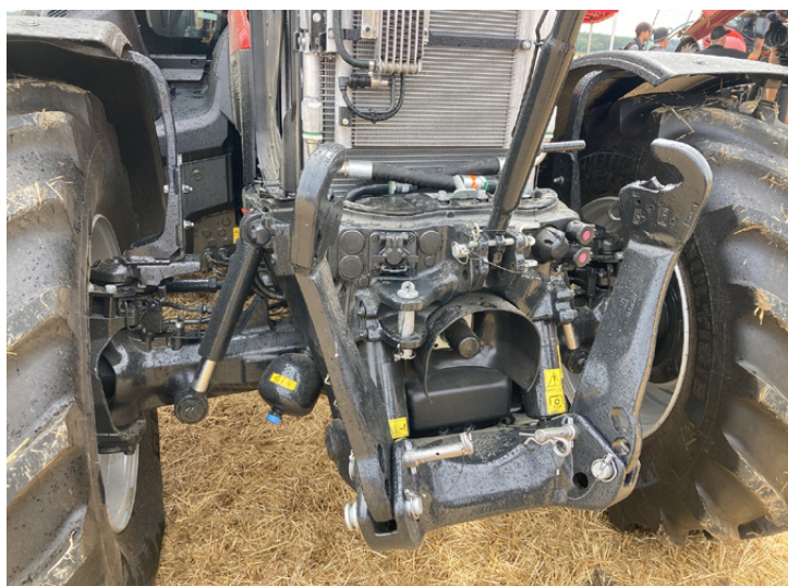
Ponte e sospensioni anteriori dei Puma sono stati completamente rifatti
