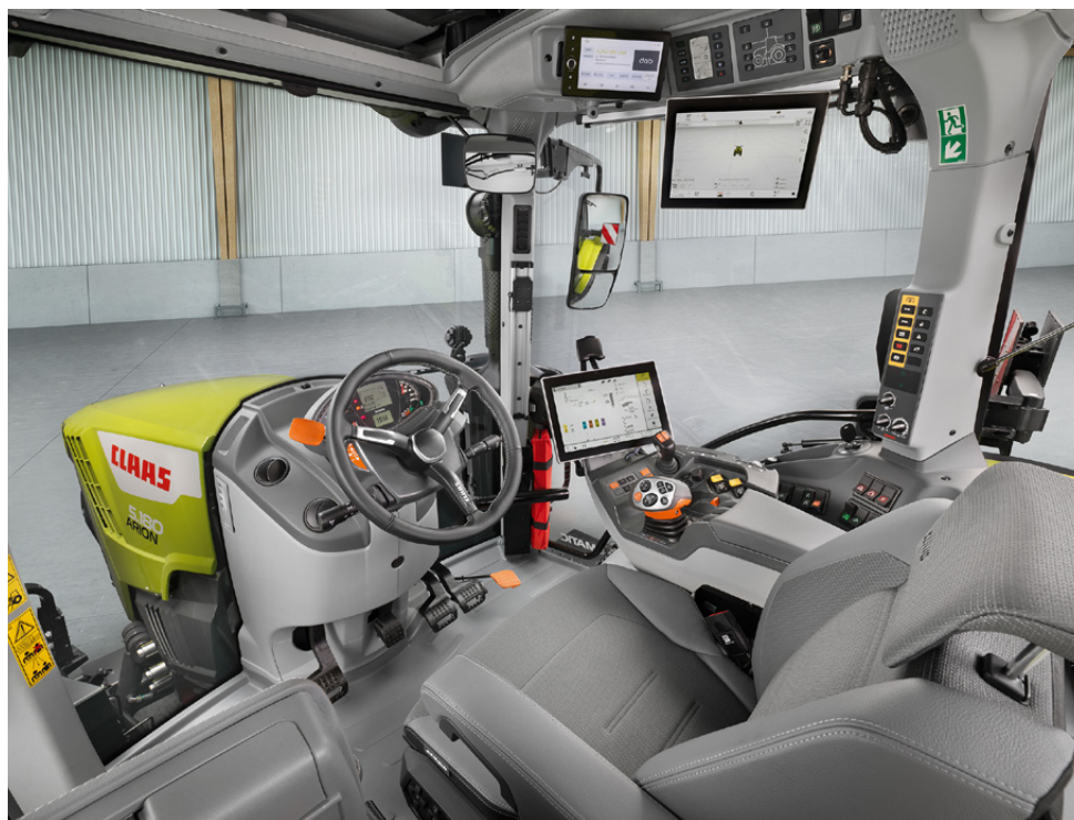
La cabina completamente sospesa e silenziosa, con dotazione Cebis e joystick Cmotion, contribuisce a garantire il massimo comfort al conducente assieme all'assale anteriore sospeso e al sistema di sterzo dinamico (disponibile come optional)
