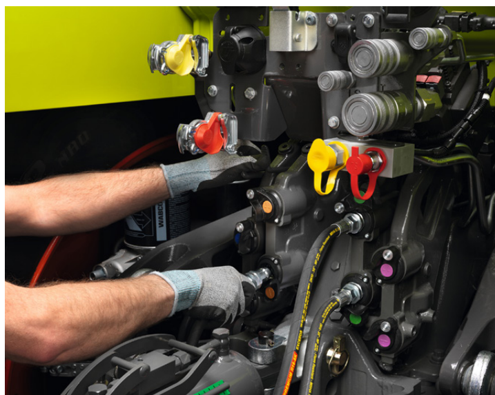
L'Arion 5 Cmatic dispone di impianto idraulico load-sensing da 150 l/min con possibilità di gestire fino a 6 distributori
